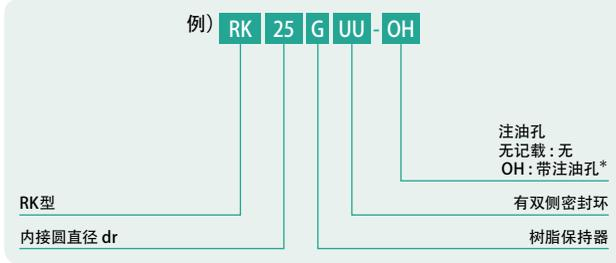
\*注油孔请使用旋转运动部位的加油用孔。
